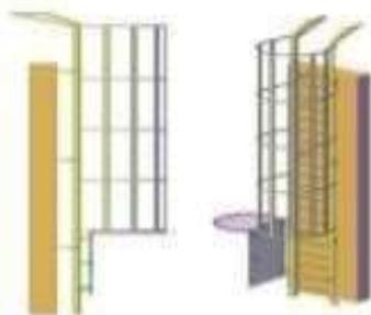
Escada marinheiro com regulagem de altura, de posição da linha de vida e dos degraus.
